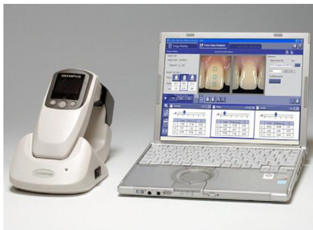
Slika 8. Spektrofotometar Crystaleye (Olympus, Tokyo, Japan) (preuzeto iz 86)
